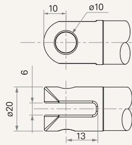
4 = 鋁加工，U型，槽寬 6.0，槽深 13.0，孔徑 6.4
