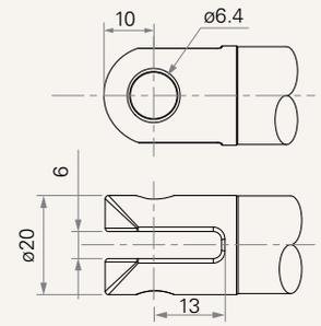
5 = 鋁加工，U型，槽寬 6.0，槽深 13.0，孔徑 8.0
